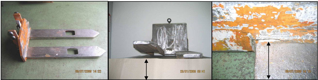
Lastgabeln sind verbogen und stark eingerissen
